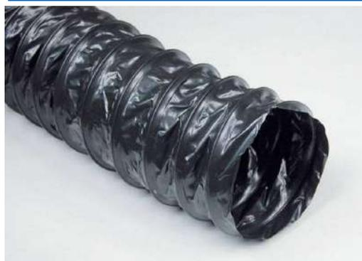
Il Flessibile per condotti di ventilazione meccanica, condizionamento dell'aria; collegamento bocchette e diffusori. E' realizzato con film di resine poliolefiniche additivate e spirale in filo di acciaio armonico. Il colore è nero.
