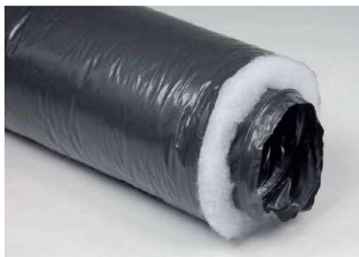
Il Flessibile per condotti di ventilazione meccanica a semplice e doppio flusso, condizionamento dell'aria; riduzione della condensa e delle dispersioni di calore. E' realizzato con film di resine poliolefiniche additivate e spirale in filo di acciaio armonico. Rivestimento termoisolante in fibra di poliestere con uno spessore di 25mm, 16Kg/m<sup>3</sup>. Protezione esterna antivapore in resina poliolefinica additivata. Il colore è nero.
